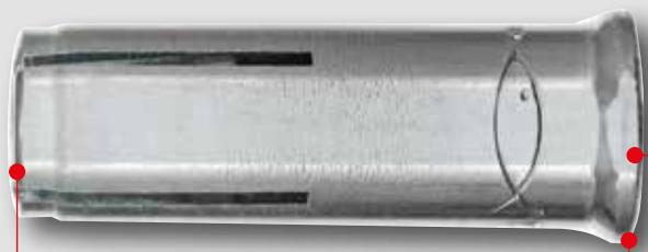
Die Einheit von Ankerhülse und innenliegendem Spreizkonus führt zu höchsten Tragfähigkeiten in gerissenem und ungerissenem Beton. Die Ankerhülse wird spanlos aus einem Stück gepresst und ist dadurch **besonders widerstandsfähig**.
