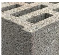
Легкий бетон (блоки с пустотами)
