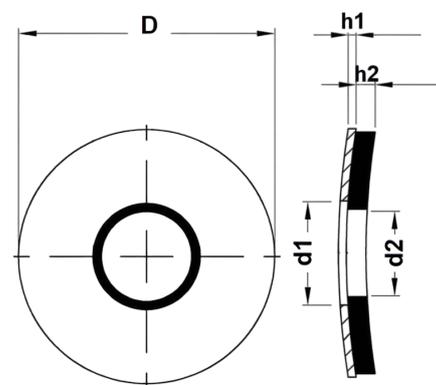
**Материал:** Шайба: оцинкованная сталь, прокладка: этилен-пропиленовый каучук EPDM
