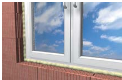
Швы оконных соединений
