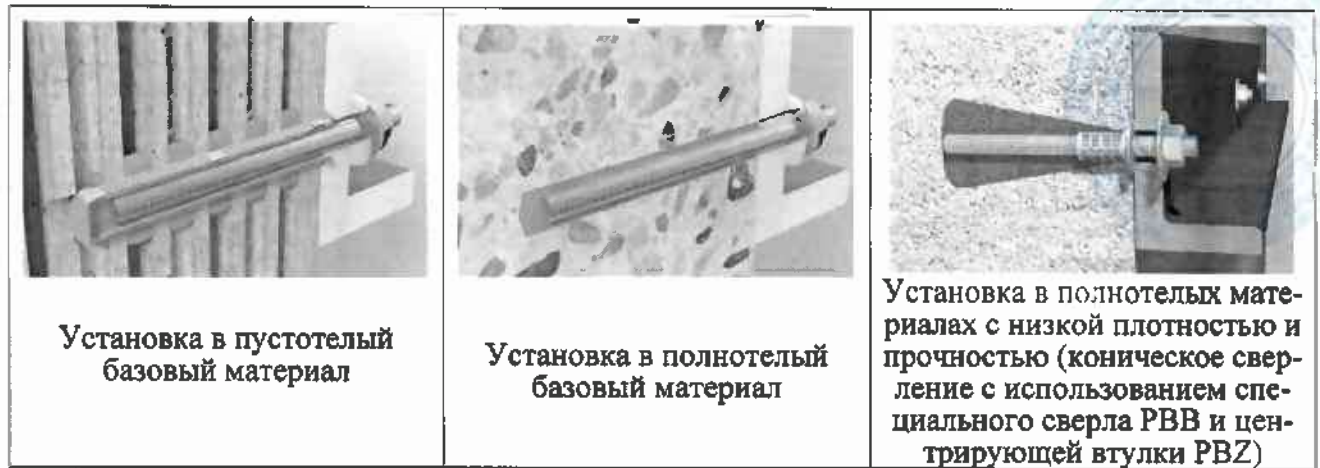
Рис.1. Примеры установки клеевых анкеров в различные типы оснований
